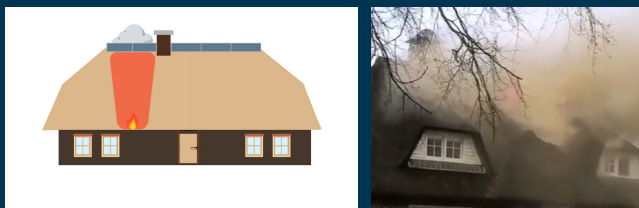
Afbeeldingen: brandverloop op traditionele dakconstructie
